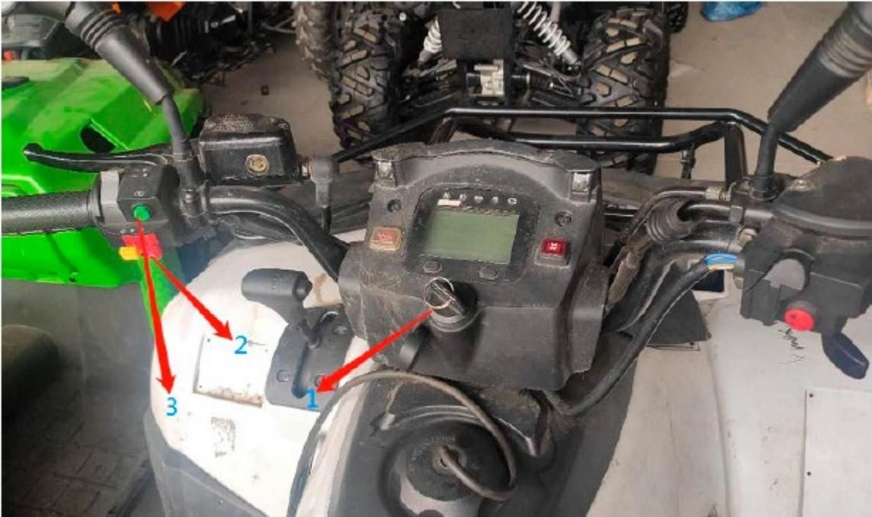
1. **Hauptschalter** - Dieser Schlüsselschalter muss im Uhrzeigersinn in die Stellung "Ein" gedreht werden, um den Motor zu starten.
