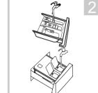
Setzen Sie die Abdeckung der Wasserenthärtungsanlage wieder ein und schieben Sie die Schublade in Position.
