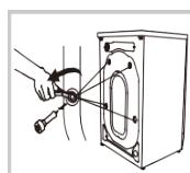
Bitte führen Sie die folgenden Schritte aus, um die Schrauben zu entfernen:
