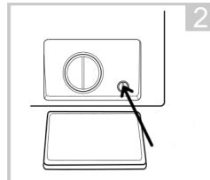
90 ° C drehen, den Notablaufschlauch herausziehen und die Schlauchkappe abnehmen
