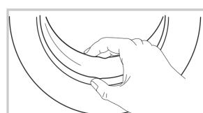
Wischen Sie das Glas und die Dichtung nach jedem Waschgang, um Fusseln und Flecken zu entfernen. Wenn sich Fusseln bilden, kann es zu Undichtigkeiten kommen.
