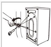
Du har brug for transportboltene igen, hvis du flytter produktet, så sørg for at opbevare dem et sikkert sted.
