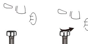
2 Verbinden Sie das andere Ende der Einlassleitung mit dem Einlassventil auf der Rückseite des Produkts und befestigen Sie die Leitung fest im Uhrzeigersinn
