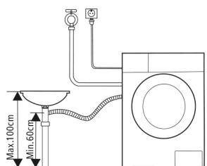
**OBS:** Om maskinen har avloppsslangstöd, installera det på följande sätt.
