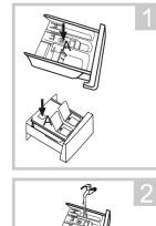
Drücken Sie die Pfeilposition auf der Weichspülerabdeckung in der Spenderschublade nach unten. Heben Sie den Clip an und nehmen Sie die Abdeckung des Weichspülerfachs heraus und waschen Sie alle Fächer mit Wasser.
