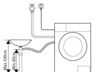
Note: Hvis maskinen har støtte til drænslanger, skal du installere den på følgende måde.
