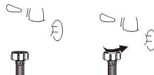
2 Tilslut den anden ende af indløbsrøret til indløbsventilen på bagsiden af produktet og fastgør røret tæt med uret.
