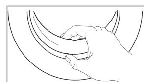
Torka av glaset och förseglingen efter varje tvätt för att avlägsna ludd och fläckar. Om ludd byggs upp kan det orsaka läckage. Ta bort eventuella mynt, knappar och andra föremål från tätningen efter varje tvätt.
