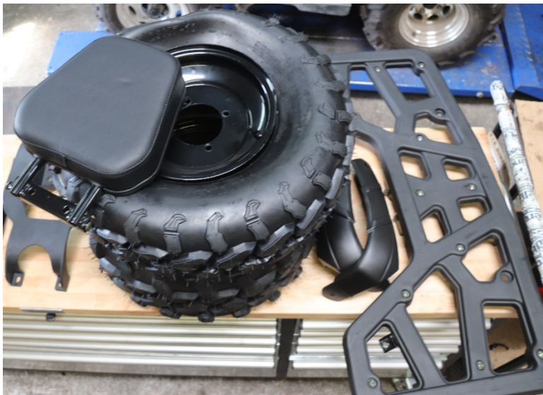
Von links: Rücklehne, Reifen, Handschutz, Gepäckträger.
