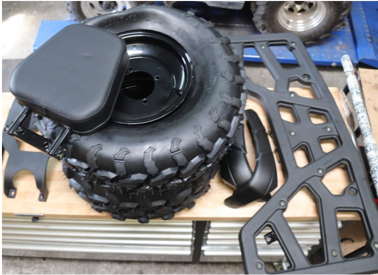
Från vänster: Ryggstöd, däck, handskydd, bakre bagagehållare.
