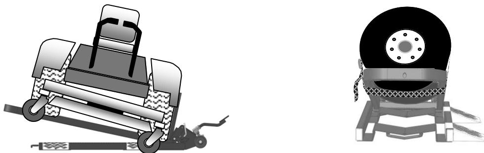
5– Terminer la levée jusqu'à l'enclenchement des butées de sécurité.
