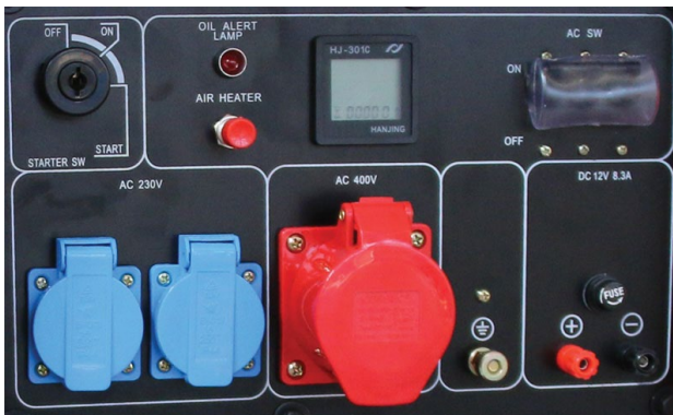
Das oben abgebildete Paneel gehört zum 3-Phasen-Modell mit 2 x 230 V Anschluss (blau) und 1 x 400 V Anschluss (rot).
