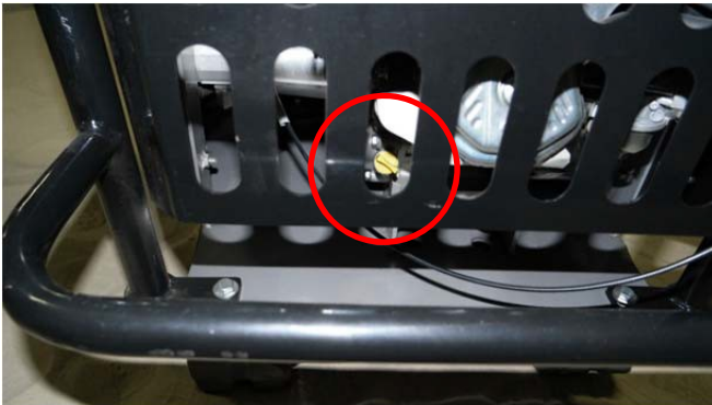
Fig. 5: Här sitter oljepåfyllningspluggen/-mätstickan.
