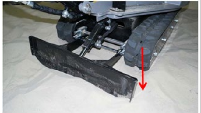
Fig. 22: Schaktbladet i nedsänkt läge
