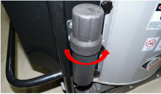
Fig. 40: Behållaren monterad på grävmaskinen
