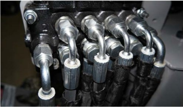
Fig. 53: Styrblock på vänster sida sett i färdriktningen.
