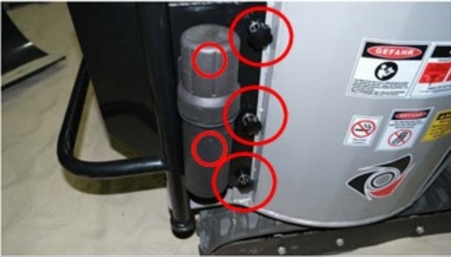
Fig. 43: Ta bort behållaren och lossa skruvarna till höger
