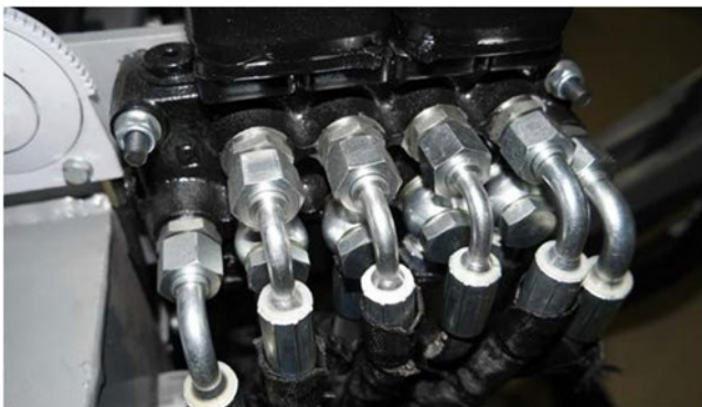
Fig. 54: Styreblok på højre side set i køreretningen.
