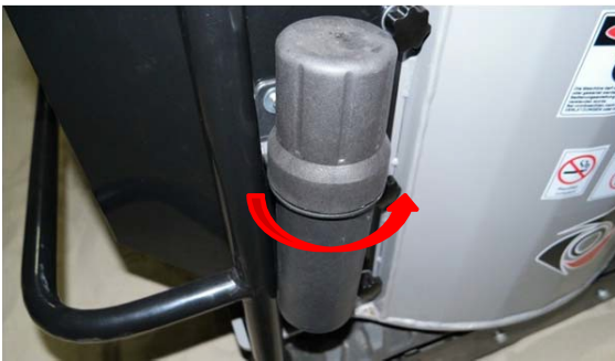
Fig. 40: Beholderen monteret på gravemaskinen
