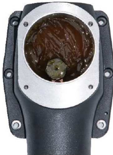
Exempel på ny smörjning (innan användning)
