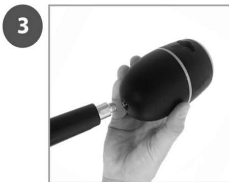
Skru kameraet fast på soklen, og juster retning og vinkel på kameraet
