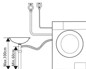
**Note:** Hvis maskinen har støtte til drænslanger, skal du installere den på følgende måde.
