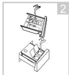
2 Setzen Sie die Abdeckung der Wasserenthärtungsanlage wieder ein und schieben Sie die Schublade in Position.
