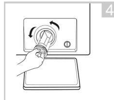
Öffnen Sie den Filter, indem Sie ihn gegen den Uhrzeigersinn drehen
