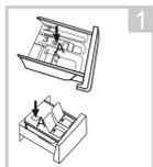
1 Drücken Sie die Pfeilposition auf der Weichspülerabdeckung in der Spenderschublade nach unten. Heben Sie den Clip an und nehmen Sie die Abdeckung des Weichspülerfachs heraus und waschen Sie alle Fächer mit Wasser.
