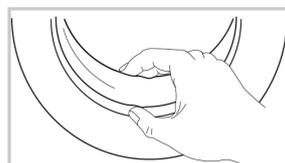
Wischen Sie das Glas und die Dichtung nach jedem Waschgang, um Fusseln und Flecken zu entfernen. Wenn sich Fusseln bilden, kann es zu Undichtigkeiten kommen.
