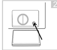
90 ° C drehen, den Notablassschlauch herausziehen und die Schlauchkappe abnehmen
