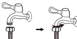
2 Tilslut den anden ende af indløbsrøret til indløbsventilen på bagsiden af produktet og fastgør røret tæt med uret.
