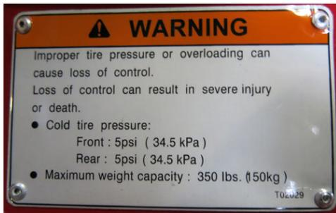
Ein falscher Reifendruck oder eine Überladung können zum Kontrollverlust führen. Ein Kontrollverlust kann zu ernsthaften Verletzungen oder gar zum Tod führen.
