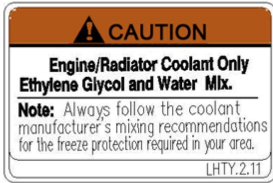
Die Motor-/Kühflüssigkeit darf ausschließlich eine Mischung aus Ethylenglycol und Wasser sein.
