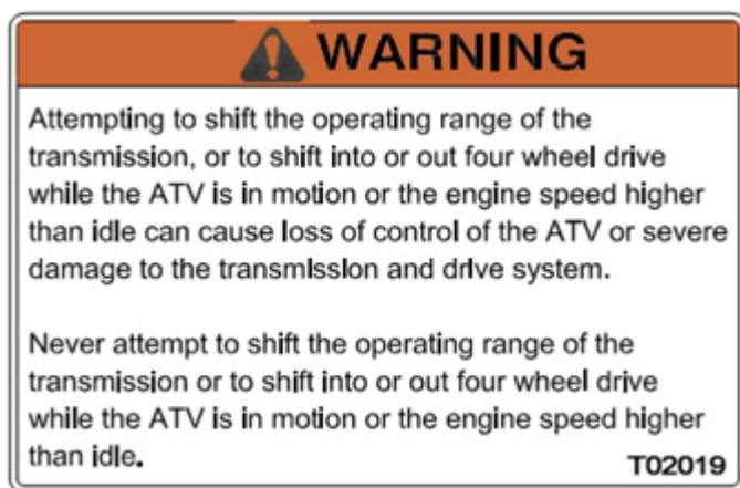
*Falls man versucht, den Gang zu wechseln oder von 2-Rad- auf Allradbetrieb oder umgekehrt zu schalten, während sich das Quad bewegt oder der Motor mit einer höheren Drehzahl als dem Leerlauf läuft, kann dies zu einem Kontrollverlust über das Quad, zu schweren Schäden an der Transmission oder dem Antriebssystem führen.*
