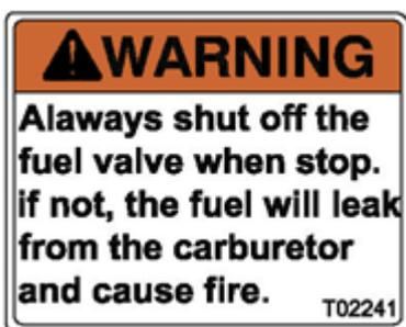
*Schließen Sie nach dem Anhalten stets den Benzinahn. Wird dies nicht gemacht, leckt Kraftstoff aus dem Vergaser und verursacht einen Brand.*
