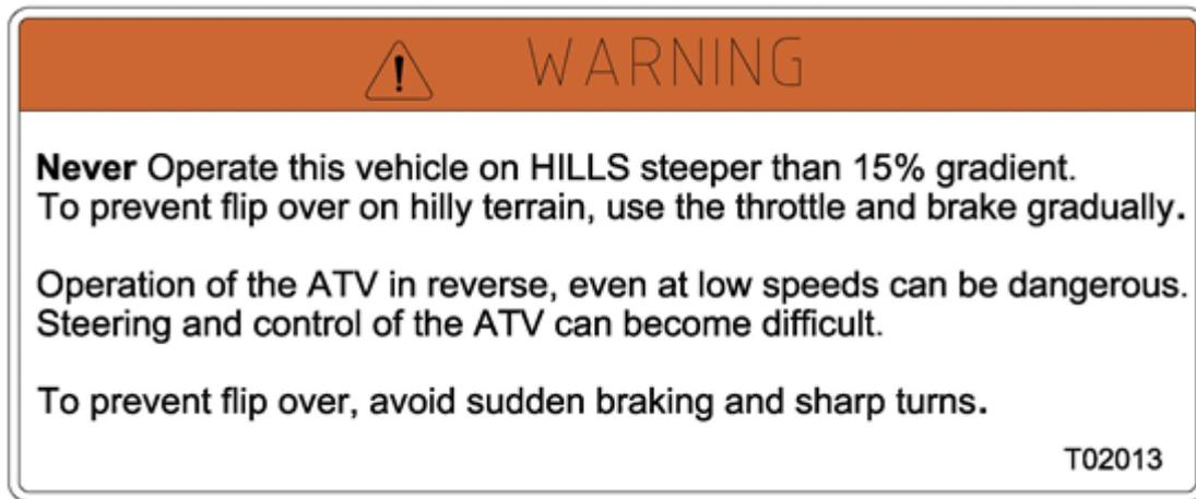
*Dieses Fahrzeug niemals auf Hügeln fahren, die steiler als 15 % sind. Um das Umkippen in hügeligem Gelände zu vermeiden, sind Gas und Bremse schrittweise zu benutzen.*
