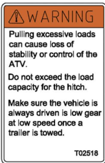
*Werden zu schwere Lasten gezogen, kann dies zu einem Verlust der Stabilität oder Kontrolle über das Quad führen. Die Zugkapazität nicht überschreiten. Sorgen Sie dafür, mit einem langsamen Gang und mit geringer Geschwindigkeit zu fahren, wenn ein Anhänger gezogen wird.*
