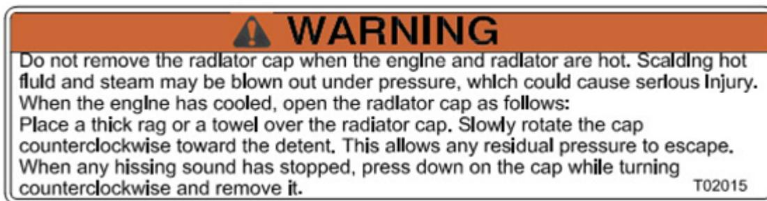
*Den Kühlerdeckel nicht entfernen, wenn Motor und Kühler heiß sind. Dies kann dazu führen, dass siedend heißes Wasser und Dampf unter Druck entweichen, was schwere Verletzungen verursachen kann.*
