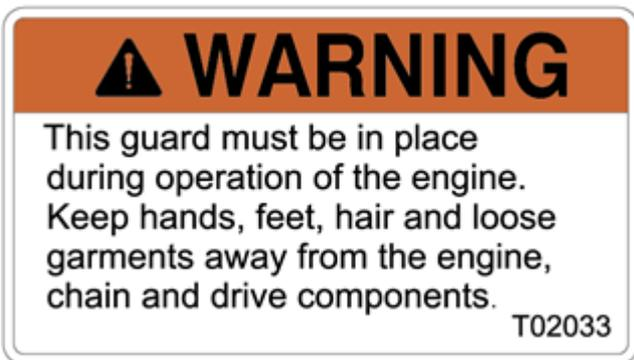
*Diese Verkleidung muss sich an ihrem Platz befinden, wenn die Maschine in Betrieb ist. Halten Sie Hände, Füße, Haare und lose Kleidung außerhalb der Reichweite von Motor, Kette und der Antriebselemente.*
