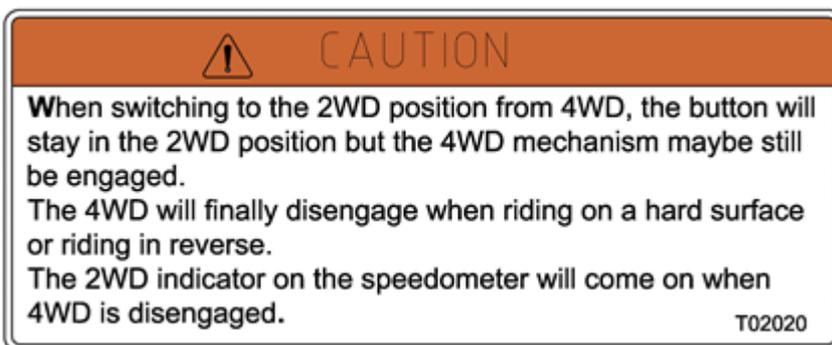
*Beim Umschalten von Allrad- auf 2-Rad-Antrieb kann der Schalter zwar auf 2-Rad stehen, aber der Allradantrieb noch immer eingeschaltet sein.*
