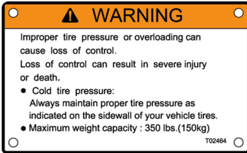
*Ein falscher Reifendruck oder eine Überladung können zum Kontrollverlust führen.
