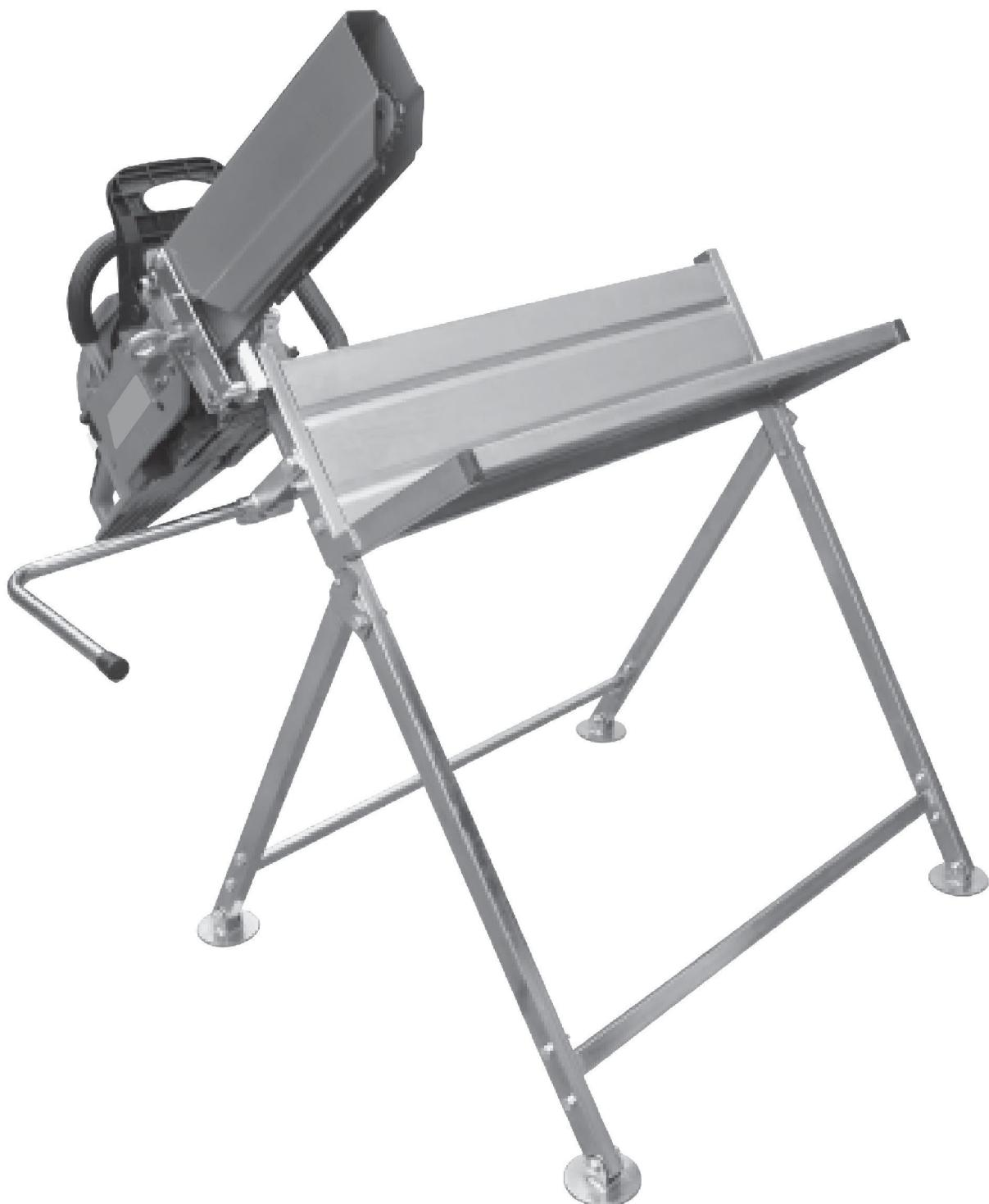
Fig. 3. Sænk forsigtigt kædesavens sværd ned i position mellem de to massive blokke i drejeklemmen, og sørg for, at der er 2 cm mellemrum mellem kædesavens krop og klemmen. Sørg for, at sværdet er ca. 90 grader i forhold til klemmen og er godt fri af kæden, før du spænder bolten. Når den er spændt, skal du teste bevægelsesbuen for at sikre, at sværdet ikke berører dele af savbukken.
