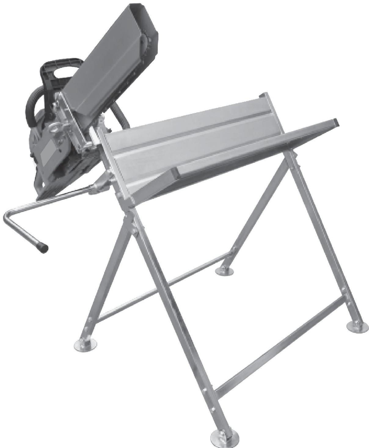
**Fig 3.** Senk motorsagsverdet forsiktig på plass mellom de to solide blokkene i den dreibare klemmen og sørge for at det er 2 cm avstand mellom motorsagen og klemmen. Forsikre deg om at sverdet er omtrent 90 grader i forhold til klemmen og godt klar av kjedet før du strammer bolten. Når den er strammet, tester du buebevegelsen for å forsikre deg om at sverdet på motorsagen ikke berører noen del av sagbenken.
