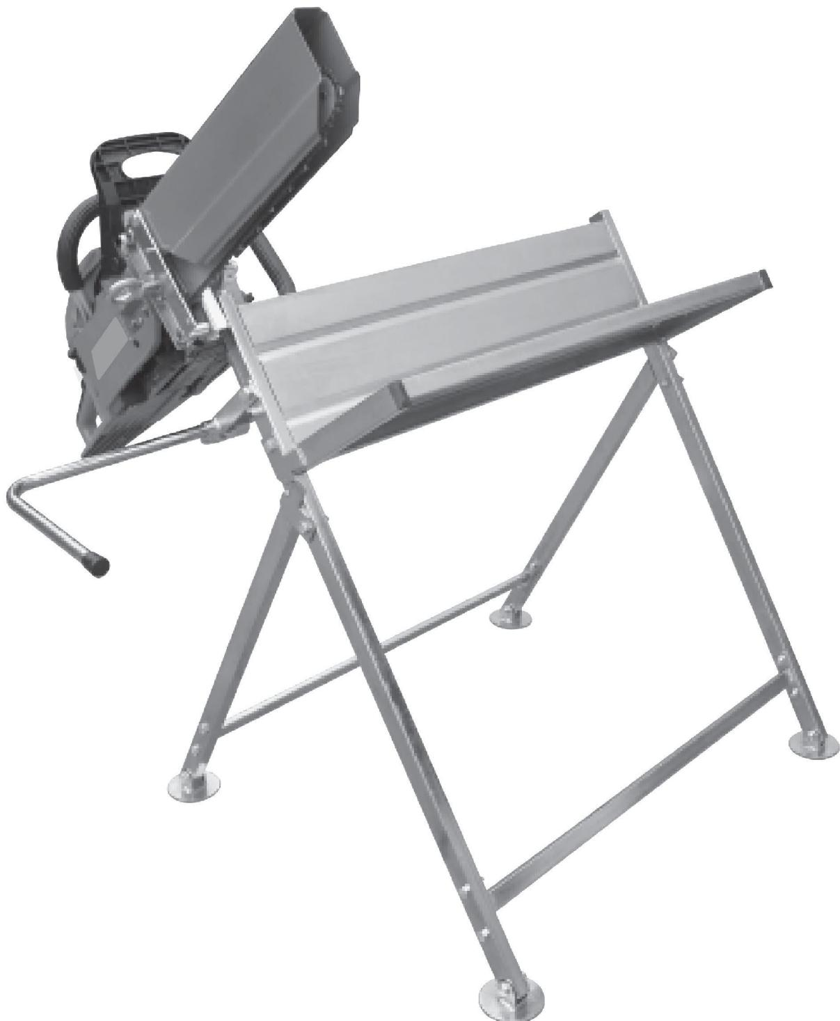
Bild 3. Sänk försiktigt ner motorsågsstången i läget mellan de två fasta blocken i svängklämman och se till att det finns ett utrymme på 2 cm mellan motorsågskroppen och klämman. Se till att stången är ungefär 90 grader i förhållande till klämman och att den är fri från kedjan innan skruven dras åt. Efter att ha dragit åt, testa rörelsebågen för att se till att kedjestången inte vidrör någon del av sågbänken.
