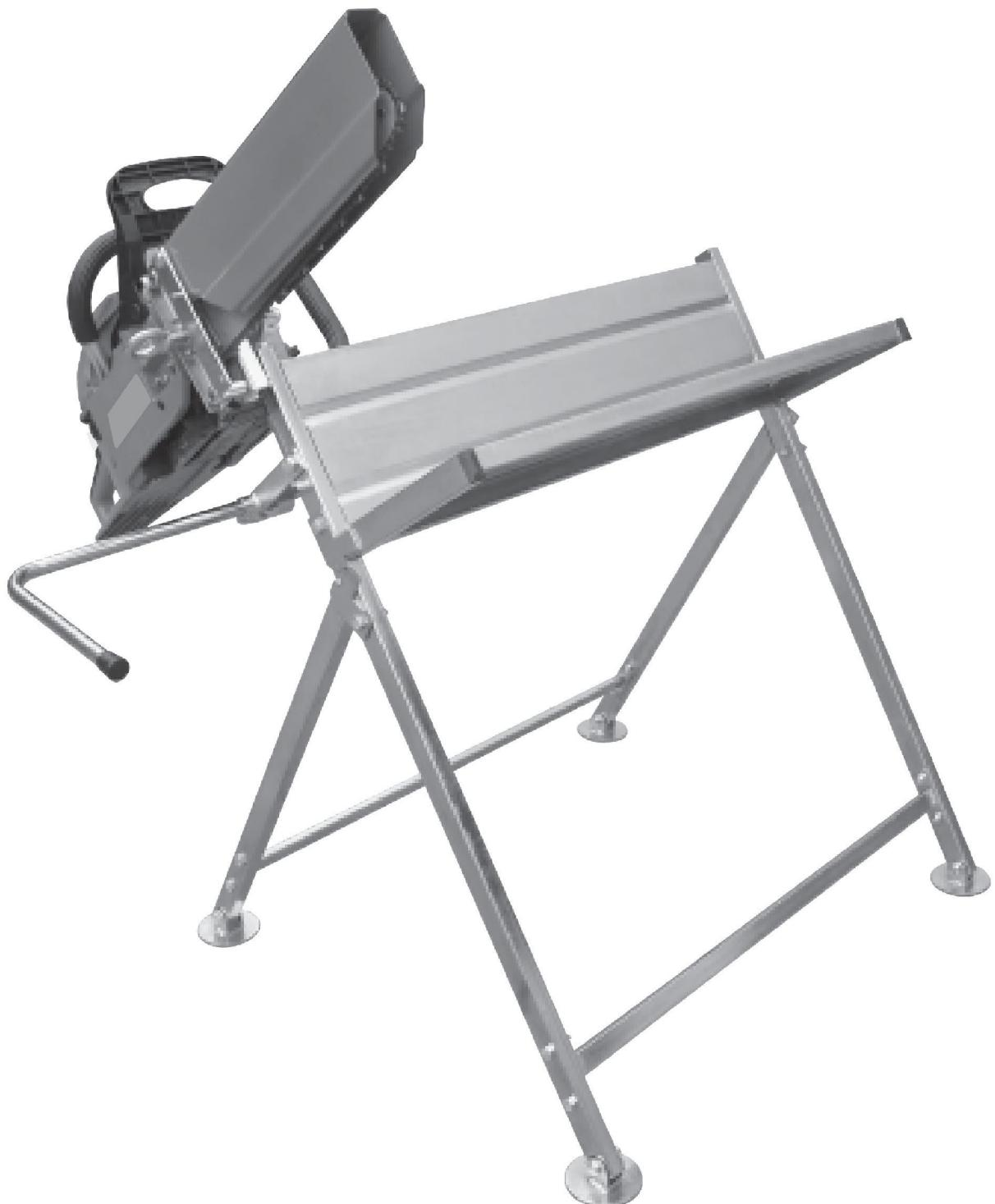
Abb. 3. Senken Sie das Sägeschwert vorsichtig in die Position zwischen den beiden massiven Blöcken in der Schwenkklemme ab und achten Sie auf einen Abstand von 2 cm zwischen dem Körper der Kettensäge und der Klemme. Vergewissern Sie sich, dass das Schwert in einem Winkel von ca. 90 Grad zur Klemme steht und einen ausreichenden Abstand zur Kette hat, bevor Sie die Schraube anziehen. Testen Sie nach dem Festziehen den Verfahrweg, um sicherzustellen, dass das Schwert die Sägebank nicht berührt.
