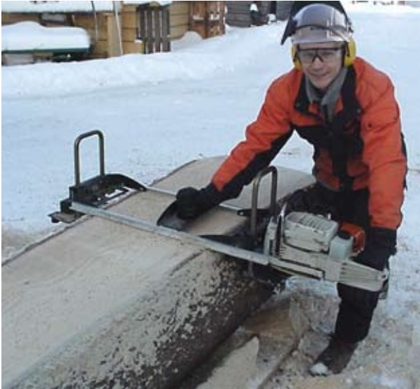
LSG utan linjaler. Stockens plana yta styr nästa skär.
