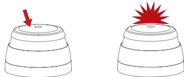
Når de andre røykvarslene mottar radiosignal, vil de røde LED-diodeene også blinke på disse.
