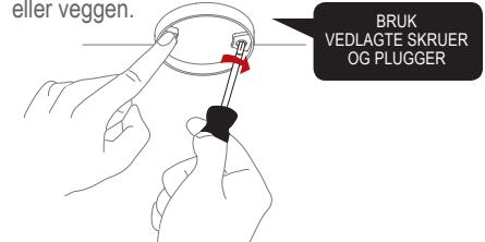
Når takbraketten er installert, fest røykvarsleren ved å vri med klokken til den klikker på plass. Hvis batteriet enten mangler eller er satt i feil, eller at bryteren står i "Læremodus", vil ikke røykvarsleren passe i takbraketten.
