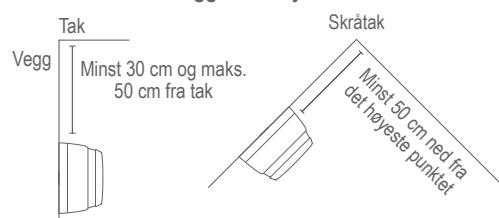
Minst én røykvarslere per etasje og maks. avstand mellom røykvarslere er 10 meter.
