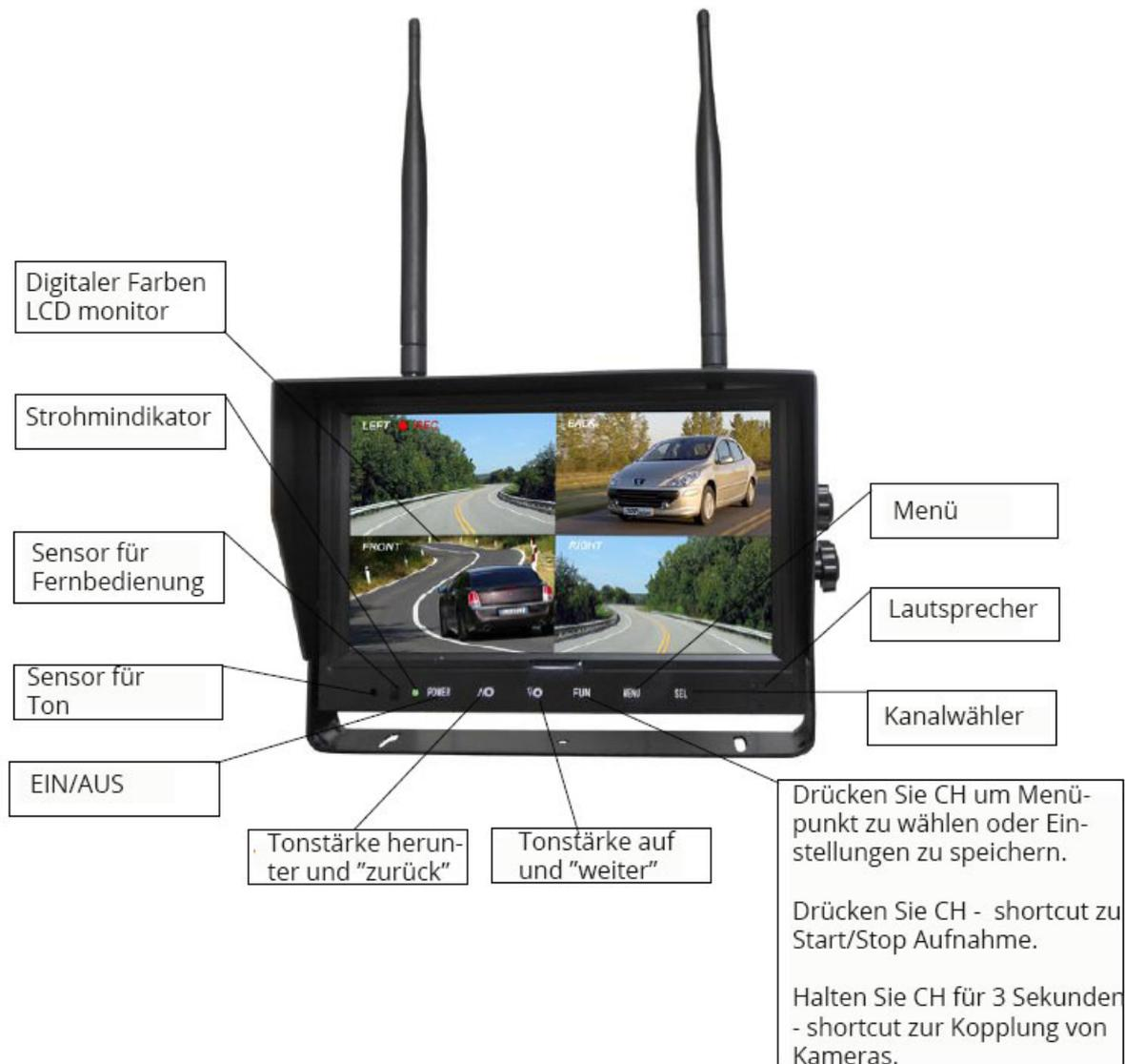
**Hinweis:** Es können kleine Glanz- oder schwarze Flecken auf dem LCD-Bildschirm vorhanden sein. Das ist normal und bedeutet nicht, dass etwas mit dem Gerät nicht stimmt. Versuchen Sie niemals, das Gerät selbst zu reparieren. Sollten Probleme auftreten, schalten Sie den Monitor aus und wenden sich an den Lieferanten oder die autorisierte Werkstatt. Jegliche Demontage oder Veränderung kann das Gerät beschädigen und die Garantie läuft ab.
