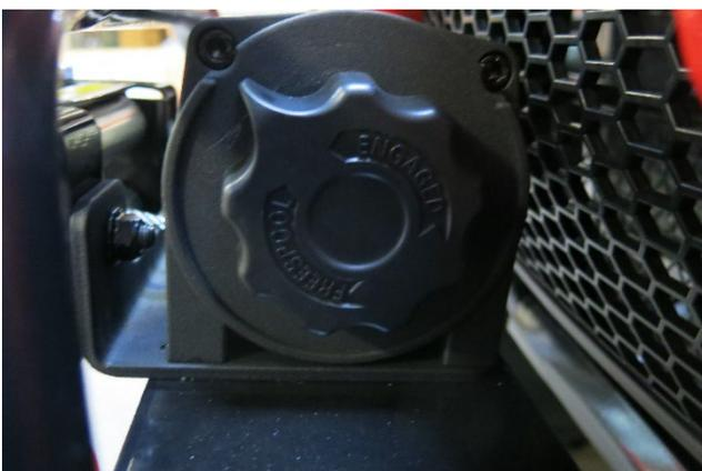
Die Winde wird vorwiegend dann verwendet, wenn das Fahrzeug stecken geblieben ist. Eine permanente Verwendung für Transportaufgaben sollte vermieden werden, da sich die Winde erhitzt und auf Dauer beschädigt wird.
