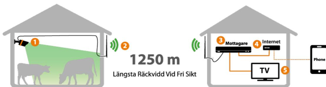
1 Die Kamera überwacht Ihre Tiere. Das Signal wird über ein Antennenkabel (9-18 m) zur Außenantenne geleitet.
