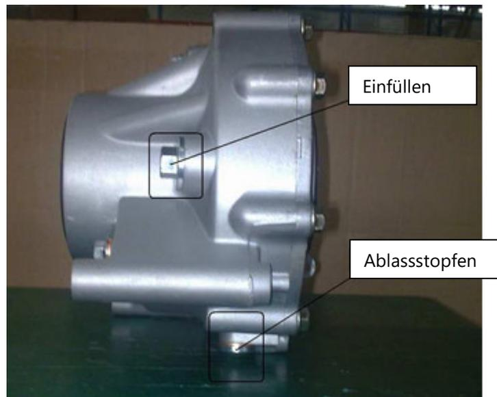
1. Entfernen Sie den Ablassstopfen, fangen Sie das Öl auf und entsorgen Sie es korrekt.
