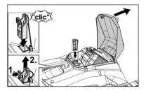
Zum Einstecken den Sicherheitsschlüssel bis zum hörbaren Einrasten nach unten drücken.
