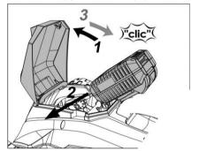
■ Zum Entnehmen die Entriegelungstaste drücken (1.) und Akku herausziehen (2.).
