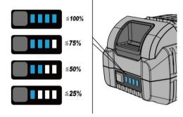
Die Anzeige erlischt nach 3 Sekunden. Blinkt eine der LED, muss der Akku geladen werden. Wenn nach dem Drücken der Taste keine LED leuchtet, ist der Akku defekt und muss ersetzt werden.
