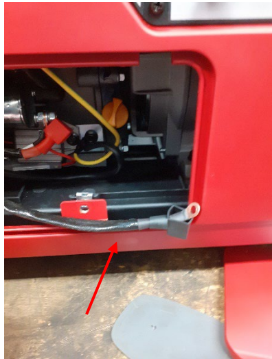
Tag ut kabeln
