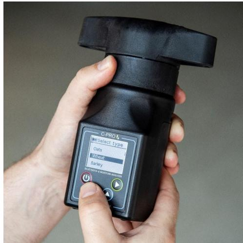
**3 Füllen die Probe in die Mahlwerk.**
