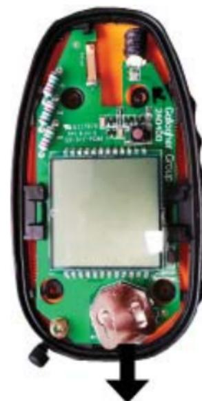
**Anmerkung:** Achten Sie darauf, dass die schwarze Dichtung genau platziert ist, damit das Fault-Finder-Gerät wasserdicht ist.
