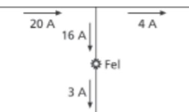
**Praktiskt Råd:** Flertrådiga stängsel, parallellkopplade, har likvärdigt strömflöde i varje tråd. För att få fram det totala strömflödet i stängslet, addera strömflödet i varje tråd.
