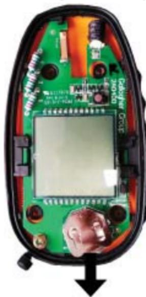
**Opmerking:** zorg dat de zwarte afdichtring weer goed wordt geplaatst om te garanderen dat de Fault Finder waterdicht is.
