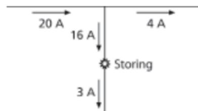
3. Indien de Fault Finder tussen twee opeenvolgende metingen een aanzienlijk lagere stroomsterkte meet, ga dan terug en meet opnieuw. Indien de meting weer omhoog gaat, weet u dat de stroomlekkage zich tussen de beide meetpunten voordoet.
