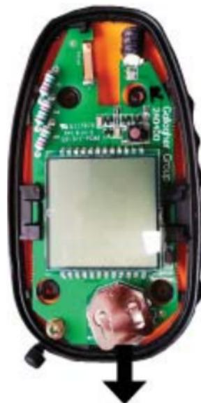
**OBS!** Försäkra dig om att den svarta tätningen är rätt placerad för att försäkra att Fault Finder är vattentät.
