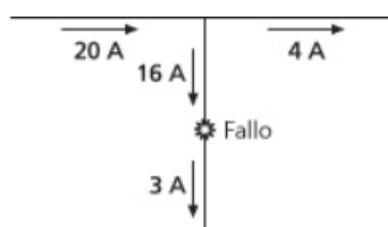
3. Un fallo se indica mediante una caída en el fluido de corriente entre dos puntos de revisión. El fallo estará en algún lugar entre estos dos puntos.
