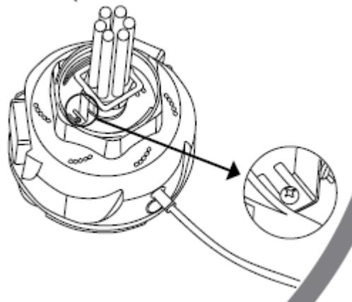
Lösen Sie die Schrauben, um den Haltebügel zu entfernen. Das Leuchtmittel kann nun aus dem Sockel herausgezogen werden.
