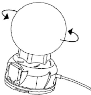
Entfernen Sie die Kuppel, indem Sie sie gegen den Uhrzeigersinn drehen.
