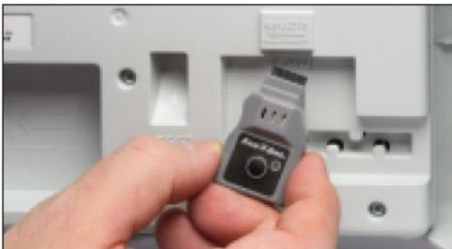
5. Aktivieren Sie die "Hot Spot"-Funktion des WiFi-Moduls, indem Sie die Taste auf dem Modul drücken. Die Lampe leuchtet abwechselnd rot und grün, um anzuzeigen, dass die Hot Spot-Funktion aktiviert ist.
