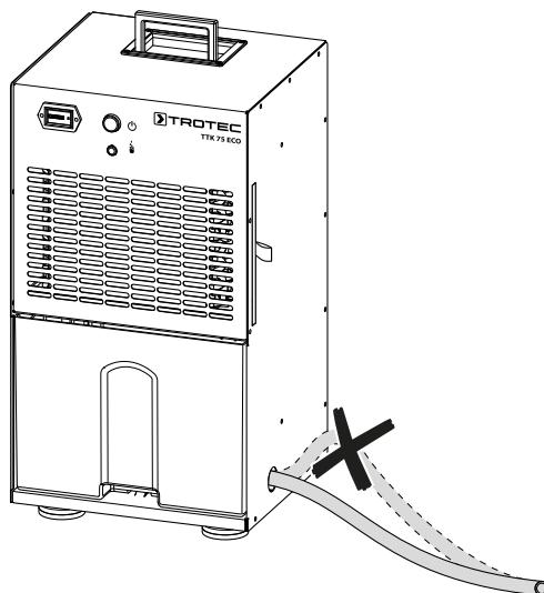
Fjern slangen hvis kondensen igjen skal samles opp via kondensbeholderen. La slangen tørke godt før lagring.
