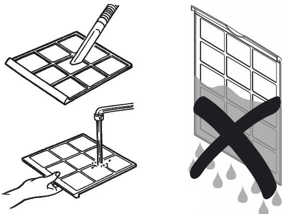
3. La filteret tørke helt. Ikke sett inn filteret i apparatet så lenge det er vått!
