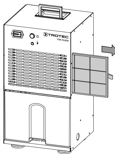
2. Rengjør filteret med en myk, lett fuktig klut som ikke loer. Dersom filteret er sterkt tilsmusset, kan du rengjøre det med varmt vann som er iblandet et nøytralt rengjøringsmiddel.
