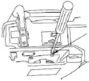
Justering af kædeolieflow
