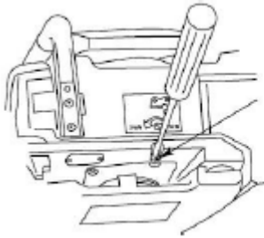
Einstellen des Kettenöflusses
