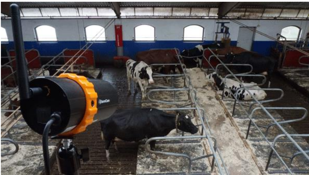
Flere kameraer på gården overvåger bl.a. dieseltanken, stalden og fodermængden. De kan også indstilles til at give en alarm ved bevægelser.
