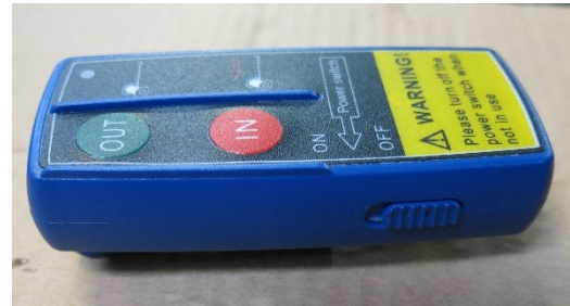
Fernbedienung für Winde – hier ausgeschaltet
