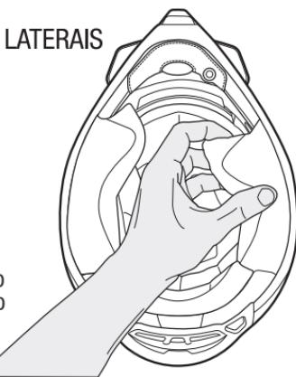
2. Remova o flange da almofada do bordo inferior do capacete ao longo da guarnição de borracha. Faça o processo inverso para voltar a instalá-lo.
