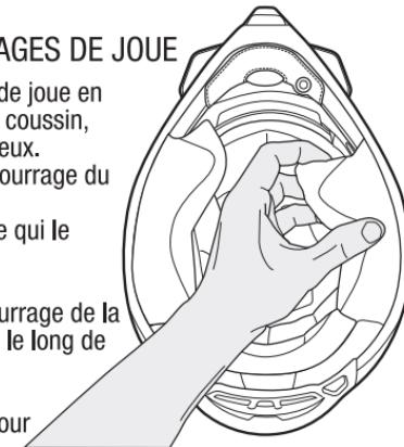
2. Retirez le rebord du rembourrage de la bordure inférieure du casque, le long de la garniture en caoutchouc.
