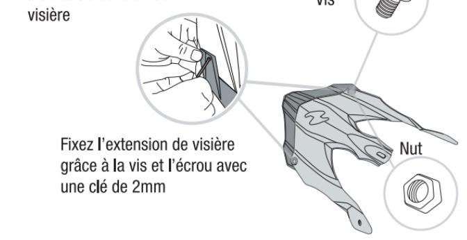
Fixez l'extension de visière grâce à la vis et l'écrou avec une clé de 2mm
