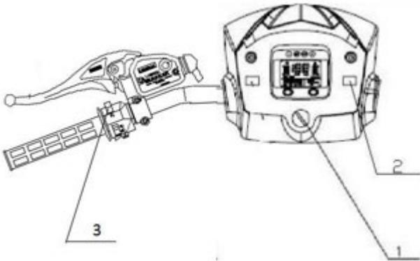
1. Hauptschalter – dieser wird im Uhrzeigersinn in die Position „ON“ gedreht, um den Motor zu starten.
