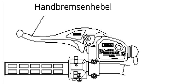
Als zusätzliche Sicherheit ist das Quad mit einer Handbremse ausgestattet. Diese befindet sich am linken Hebel und wird mit der linken Hand bedient. Sie ist als Back-up für das Hauptbremssystem gedacht, besonders dann, wenn dieses versagt. Falls die Hinterräder ins Schleudern kommen, muss die Handbremse vorsichtig aktiviert werden. Wird bergab zu stark gebremst, kann sich das Fahrzeug vorwärts überschlagen.
